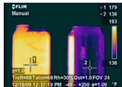
Figura 2 - Objetos na mesma temperatura com emissividades diferentes. Fonte: [www.flir.com](http://www.flir.com)
