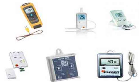
Figura 1 - Modelos de termômetros e dataloggers de diferentes fabricantes. Fonte: Elaborado pelo autor
