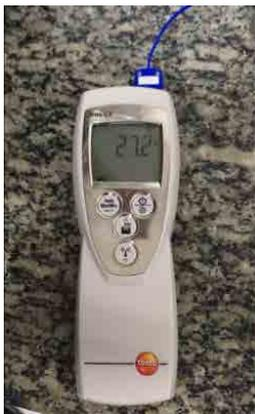
Figura 4 - Modelo de termômetro com sensor termopar tipo T (sem encapsulamento)
